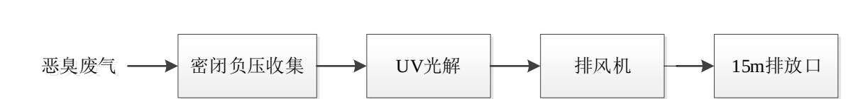
图 2-5 废气工艺流程图
